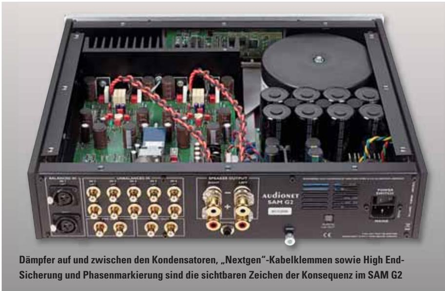
Dämpfer auf und zwischen den Kondensatoren, „Nextgen“-Kabelklemmen sowie High End-Sicherung und Phasenmarkierung sind die sichtbaren Zeichen der Konsequenz im SAM G2
