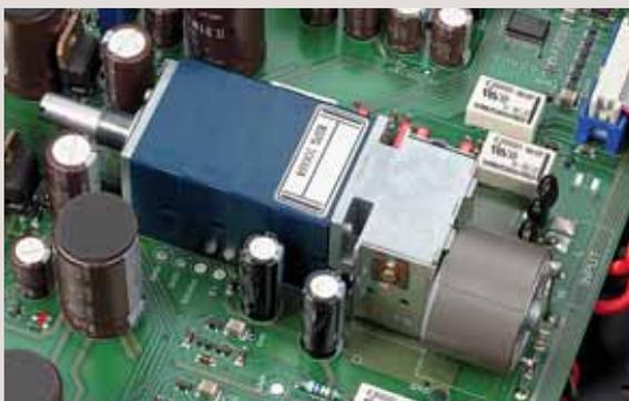
Wer hier die Phase verdreht, ist selbst schuld: markierter Netzeingang (o.l.), die hochwertige Padsicherung ist Serie (o.r.). Skurril: das Motorpoti ohne Knopf auf der Achse
