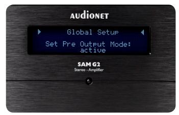
Um den Vorstufenausgang des SAM G2 zu nutzen, muss er zuvor aktiviert werden. Dazu ruft man das Setup-Menü auf und bewegt sich mit den Tasten "Down" und "Up" durch die Untermenüpunkte. Auf gleiche Weise erfolgt dort die Einstellung gewünschter Parameter, eine abschließende Bestätigung ist nicht nötig
