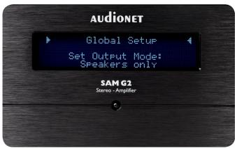
Der rückseitige Kopfhörerausgang ist ebenfalls schaltbar, daher können wahlweise nur die Lautsprecherausgänge oder nur der Kopfhörerausgang sowie beide Ausgänge parallel Signale ausgeben
