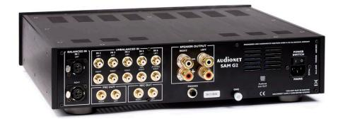
Der SAM G2 ist unsymmetrisch aufgebaut, um einen bestmöglichen Signal-Rauschabstand zu erzielen. Zwecks Kompatibilität mit symmetrischen Verkabelungen stellt er allerdings auch einen XLR-Eingang bereit, dessen Signale aufwändig desymmetriert werden
