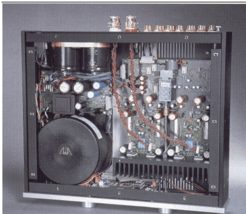
Mustergültig: Das massive Netzteil (links) speist eine blitzsauber konzipierte Verstärkerschaltung
