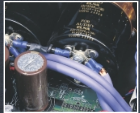
Audiophile Verdrahtung ist selbstverständlich, hier bei den beiden liegend angeordneten Netzteil-Kondensatoren
