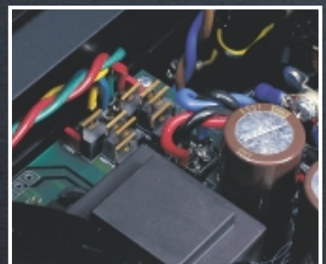
Statt der häufig verwendeten Brückengleichrichter kommen hochwertige Einzeldioden zum Einsatz
