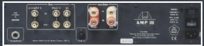
Raritäten: Die Endstufe kann mit Kopfhöreranschluss sowie Gleich- und Wechselspannungseingang aufwarten
