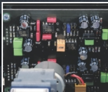
Unmittelbar hinter der Rückplatte des Vollverstärkers schieben Operationsverstärker von Burr-Brown Dienst
