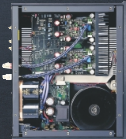
Unmittelbar hinter der Rückplatte des Vollverstärkers schieben Operationsverstärker von Burr-Brown Dienst
