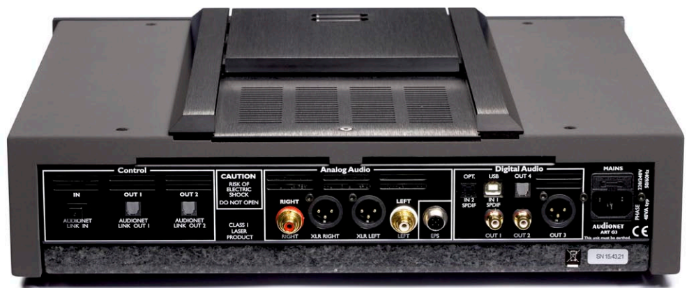
Auf der Rückseite des ART G3 befindet sich auch ein kombinierter S/PDIF-USB-Eingang, Musikfiles vom Rechner können so ebenfalls von der Digitaltechnik sowie dem für die Filter- und die Ausgangsstufe des ART G3 betriebenen Aufwand profitieren
