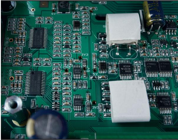
Die PLL-Schaltung wird von ultrastabilen, getrennten und gedämmten Quarzen unterstützt
