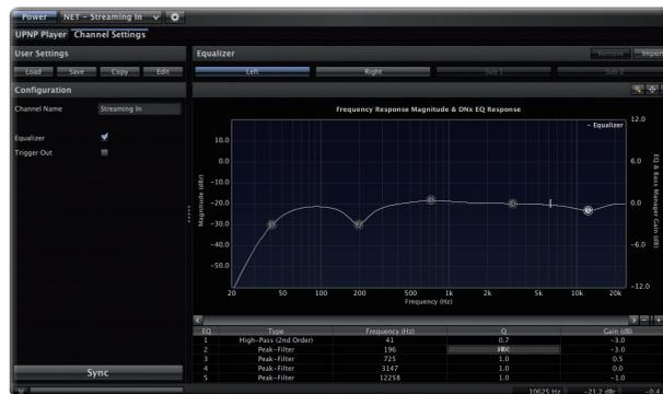
Die Windows-Software RCP ermöglicht die rasche Einstellung des Equalizers
