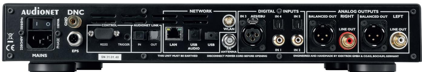
Riesige Anschlussvielfalt: Sechs digitale Quellen sind anschließbar, außerdem gibt's noch eine LAN-Verbindung und UKW-Buchse
