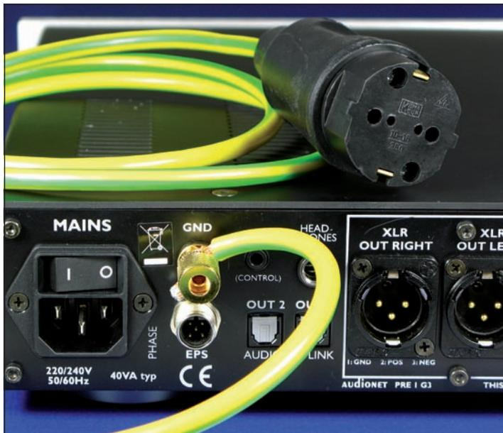
Dem Vorverstärker liegt ein extra fettes Erdkabel (GND) bei. „EPS“ dient dem Anschluss eines optionalen, externen Netzteils. „Headphones“ müssen hinten ran.
