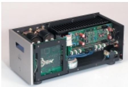
*Elektrisch und mechanisch sinnvoll: kompakter Aufbau mit kurzen Wegen, Kühlkörper nach dem Kaminprinzip*
