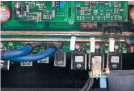
*Stromschienen: Im Endverstärker garantieren dicke Kupferschienen ungestörte Stromzufuhr zu den Endtransistoren*
