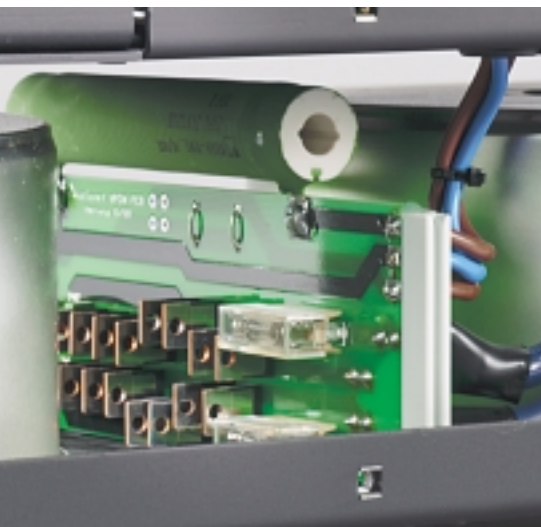
Der dicke Widerstand (oben) reduziert die brachialen Einschaltströme der beiden massiven Ringkerntransformatoren
