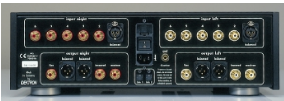
Beim PRE G2 handelt es sich um ein reinrassiges Doppelmono-Design mit grundsätzlich unsymmetrischer Signalverarbeitung – nach den XLR-Buchsen wird desymmetriert
