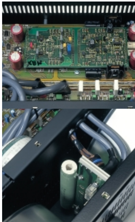
SMD-Technik beansprucht nicht nur weniger Raum, sondern bietet auch elektrische Vorteile (Bild oben). Ein riesiger Draht-Hochlastwiderstand zwischen den Trafos entlädt die Netzteile nach dem Ausschalten (Bild unten)
