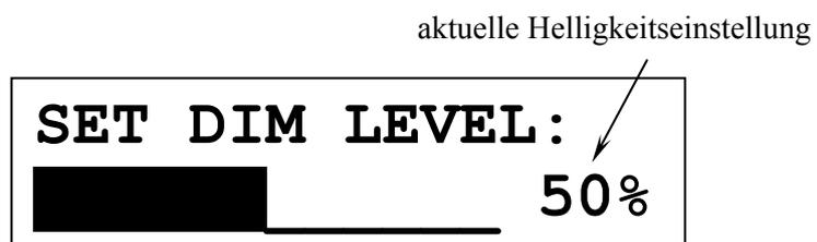
Im Anzeigefenster wird zusätzlich die aktuelle Helligkeit in Prozent angegeben und durch einen Balken entsprechender Länge versinnbildlicht.
