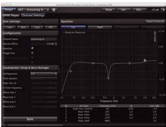
Per RCP-Software hat man vollen Zugriff auf alle Funktionen des DNA – so kann beispielsweise der Raum-EQ ganz besonders komfortabel eingestellt werden
