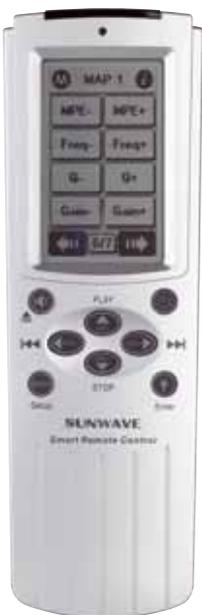
Für die Einrichtung und schnelle Nachjustierung liegen die entsprechenden Tasten „offen“ auf den Unterseiten des MAP I-Menüs. Die Fernbedienung wird auch durch einen Bewegungssensor aktiviert
