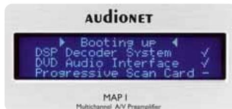
Vor dem Einschalten wird ein Selbsttest durchgeführt, bei dem auch die zusätzlich installierten Karten angezeigt werden
