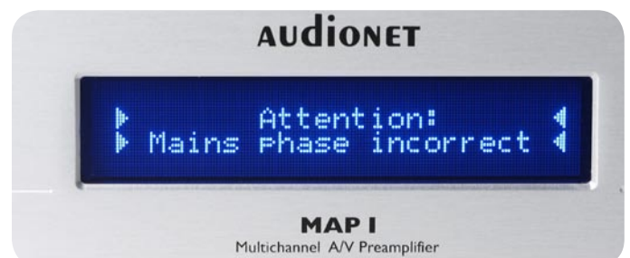
Früher wurden Materialschlachten geschlagen, um das letzte Quantchen Qualität zu erzeugen. Heute ist konstruktive Intelligenz gefragt, die für das Höchstmaß an Klangqualität sorgt. Der MAP I sagt sogar, in welcher Steckerstellung das Optimum erreicht wird
