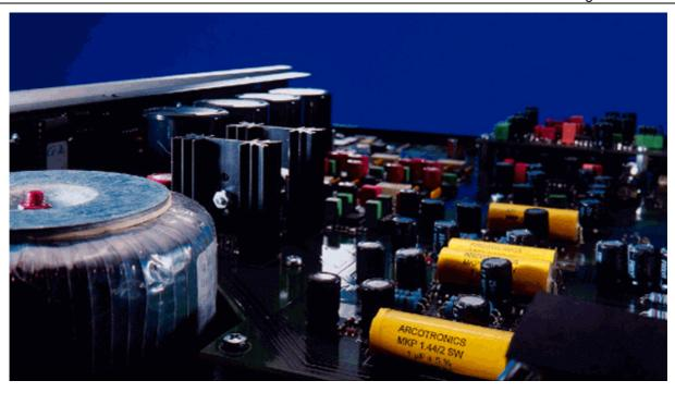
Stark wie ein Vollverstärker: Das Netzteil mit dem üppigen 100 VA-Ringkerntrafo (vorn) und 40 000 Mikrofarad Siebkapazität macht auch bei höchsten Anforderungen nicht schlapp. Die Einzelplatinn sind weitgehend mit Signalweg-verkürzenden Auflötbauteilen (SMD) bestückt.
